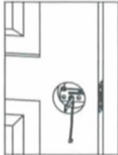
5. Pase el cable de alambre a través del pequeño orificio cuadrado en el lado derecho de la placa de montaje.
